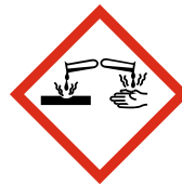
Syövyttävät aineet, vakavan silmävaurion vaaraa aiheuttavat aineet.
